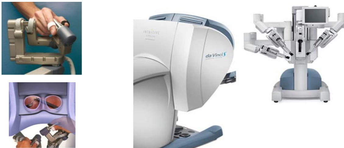
Fig.: Los dos elementos del robot quirúrgico da Vinci: Consola de mando y robot multibrazo. En la consola un objetivo binocular permite disponer de una imagen tridimensional del campo quirúrgico. Los sensores manuales reproducen con exactitud los movimientos del cirujano.
